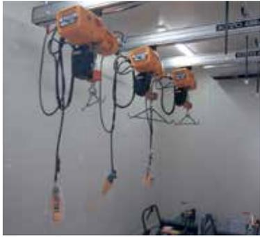
電動チェーンブロック、100 kgにもなるイノシシ等を吊り下げ、計量、移動します。
